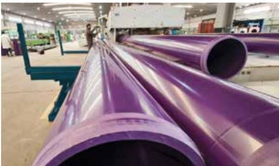
Notre dernier ajout à la gamme de familles est VIODA, un produit innovant fabriqué à partir de résine en PVC poudre vierge. Conforme aux normes de référence les plus strictes, notamment la norme NM ISO 1452-2, VIODA est spécialement conçu pour répondre aux besoins de transport sous pression des eaux usées traitées destinées à l'irrigation des espaces verts urbains.
