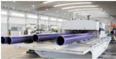
SICDA a réalisé pour la REDAL un projet important d'équipement en système d'arrosage des villes de Rabat et Salé par les eaux usées via des tubes PVC pression violets DN315 et DN400.
